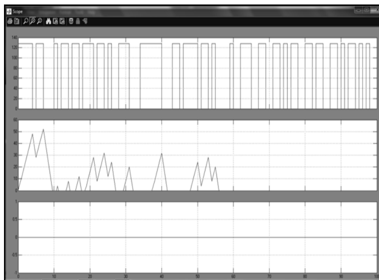
Рис.8. Осциллограммы результатов моделирования при максимальном значении интенсивности обслуживания: а) входящие пакеты; б) заполнение очереди; в) количество потерянных бит
