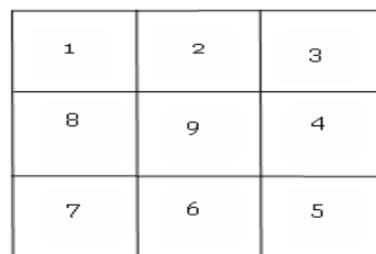
Рис.2 б. Схема обозначения пикселей в девятиэлементном окне
